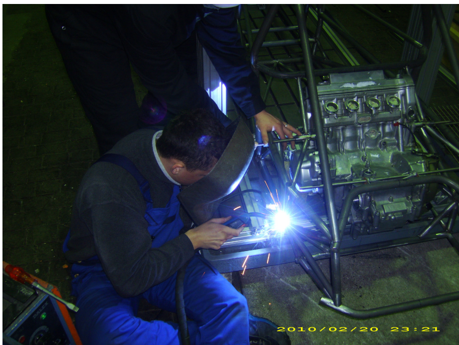
Schweißen der Motoraufhängung des RUSH 10
